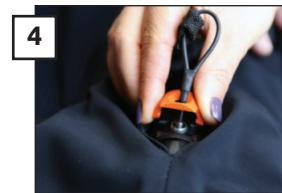
4/ Replacer la bille dans son logement. L'anneau autour de la bille doit être positionné bien à plat. Positionnez le clip orange dans son emplacement. Commencez à visser le bouchon.
