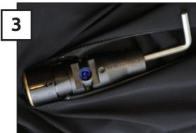
3/ Remettez le piston en place à l'aide de la clé Allen ou de votre doigt. Veillez à ce que l'encoche du piston soit bien en face du trou où viendra se placer la bille.
